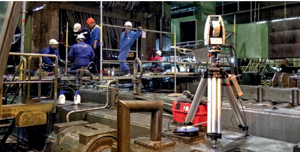
Vermessung eines Walzenständers mit dem Lasertracker AT401 von Leica.
