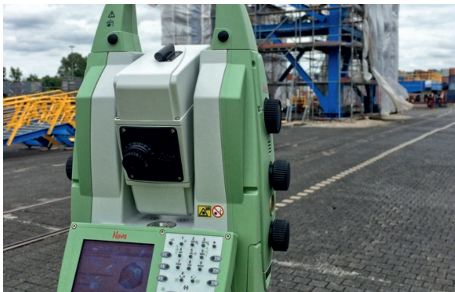
Beckers Totalstation Leica TS 50 an einem Schiffsentlader für Baffinland.
